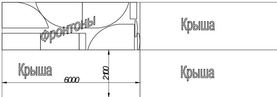
Схема раскroя поликарбоната для теплицы 3x6 м
